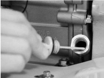
Fig. 4 – Kontrola hladiny motorového oleja
