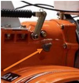
Fig. 5 – Kontrola hladiny prevodového oleja
